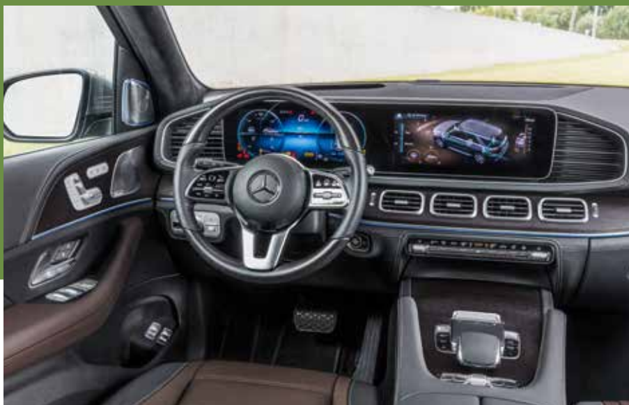
Unikátní přístrojová deska obsahuje dva širokoúhlé displeje o úhlopříčce 12,3 palce.
