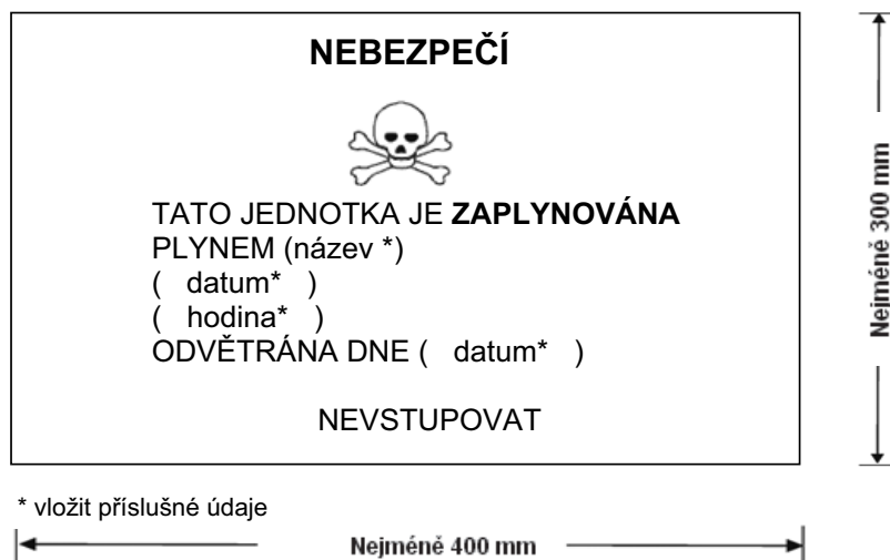
Výstražná značka pro zaplyňovanou jednotku
