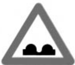
A 7 Nerovnost vozovky
