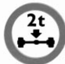
B 14 Zákaz vjezdu vozidel, u nichž okamžitá hmotnost připadající na nápravu přesahuje vyznačenou mez
